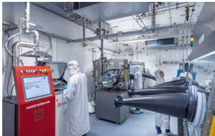
Das Fraunhofer ISE setzt beim Herstellungsverfahren für Perowskit-Silizium-Tandemsolarzellen auf die sogenannte „Hybrid-Route“, der Kombination von Vakuum- und nass-chemischen Prozessen.
