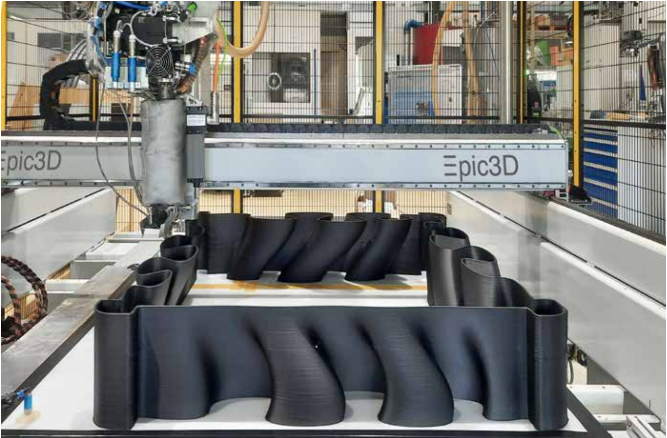
Der neue Portaldrucker Epic3D erlaubt die additive Herstellung besonders großer Bauteile.
