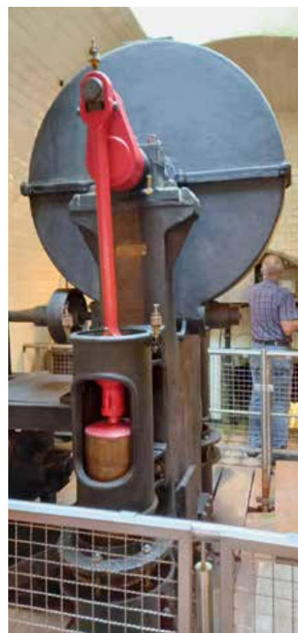
Die Solepumpe, darüber befand sich die Dampfmaschine.
