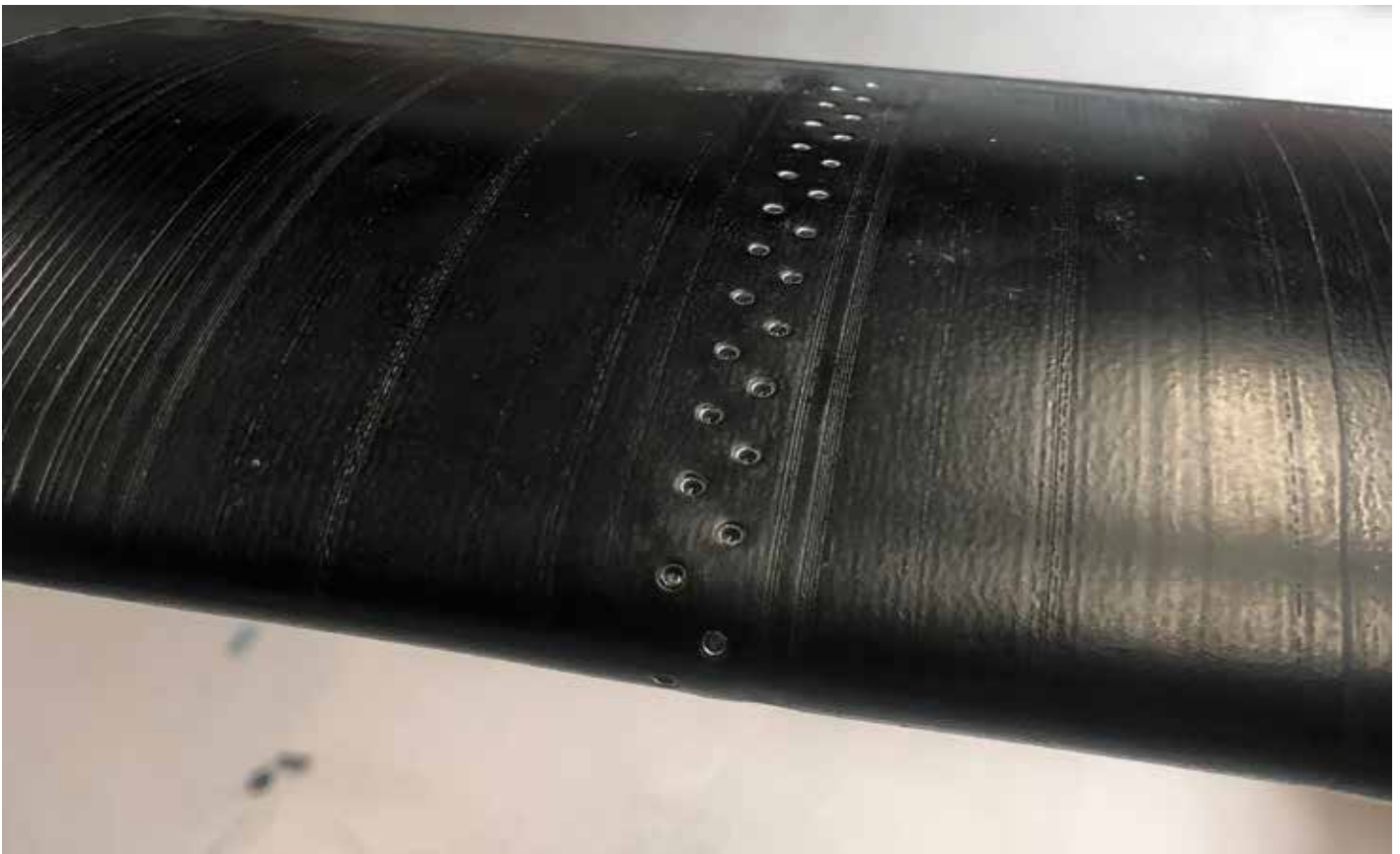
Aufgetragen auf Rotorblättern von Windkraftanlagen misst Aerosense die aerodynamische Performance und leitet die Daten kabellos weiter.
