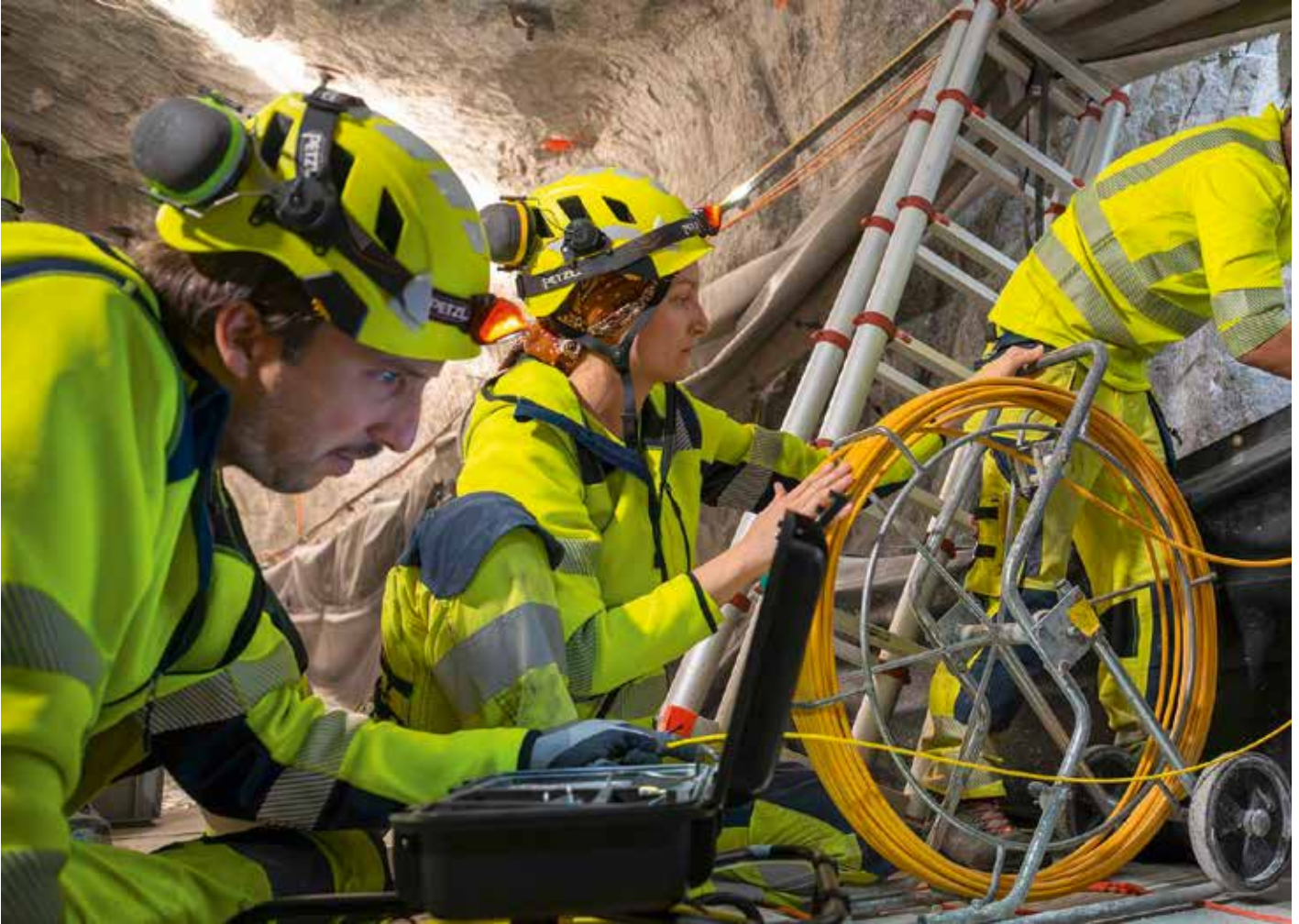
ETH-Forschende überprüfen mit einer Kamerasonde, ob der Sensor im Bohrloch richtig platziert ist.
