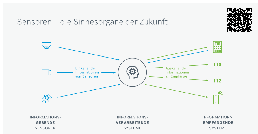
Brandschutz mit Hilfe von Sensoren – den Sinnesorganen der Zukunft.
