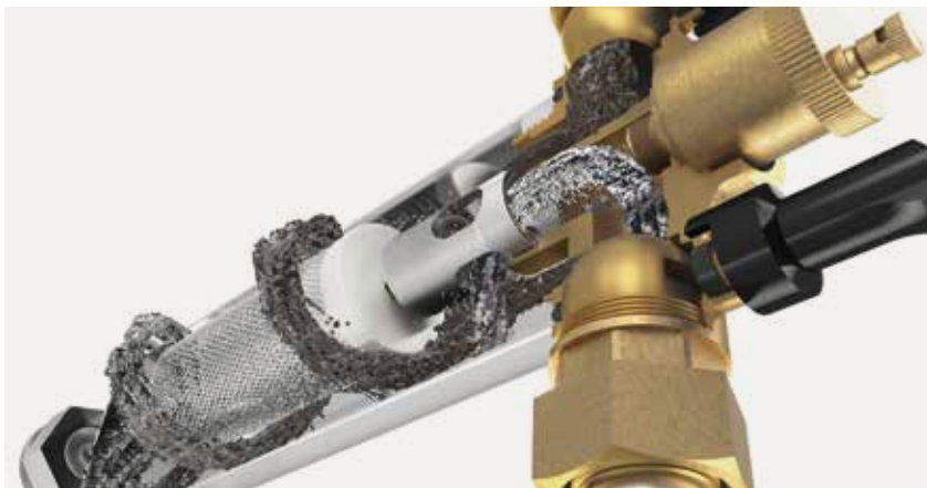
Aufgeschnittener Verteiler Verschlämmung durch Sauerstoffkorrosion.
