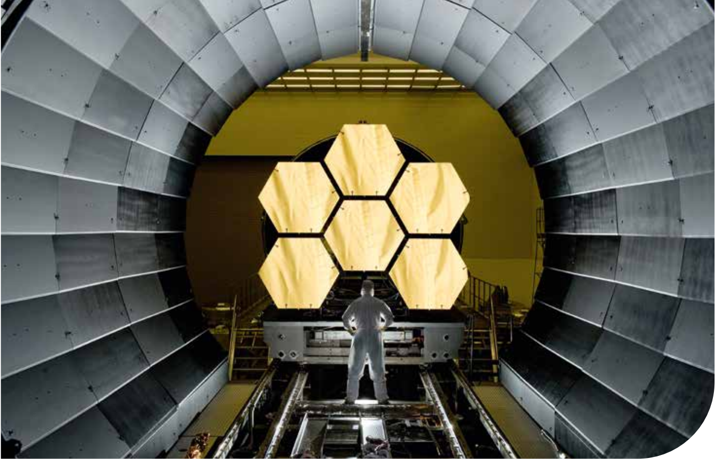
Hauptspiegel des James-Webb-Teleskops (hier in der Vorbereitungsphase). Sechs von insgesamt 18 Segmenten des Hauptspiegels des James-Webb-Teleskops werden bei der NASA für die abschliessenden Tieftemperatur-Tests vorbereitet.
