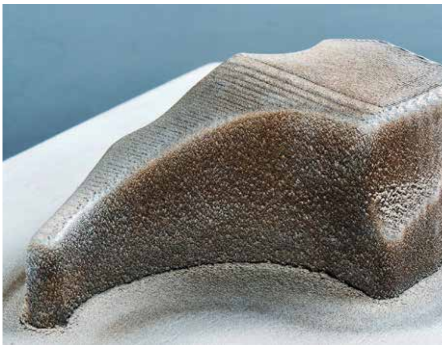
Schnell und präzise: Am Beispiel der additiven Fertigung eines Formbauteils mittels EHLA 3D konnte eine deutlich verkürzte Druckzeit im Vergleich zum LMD und LPBF demonstriert werden.
