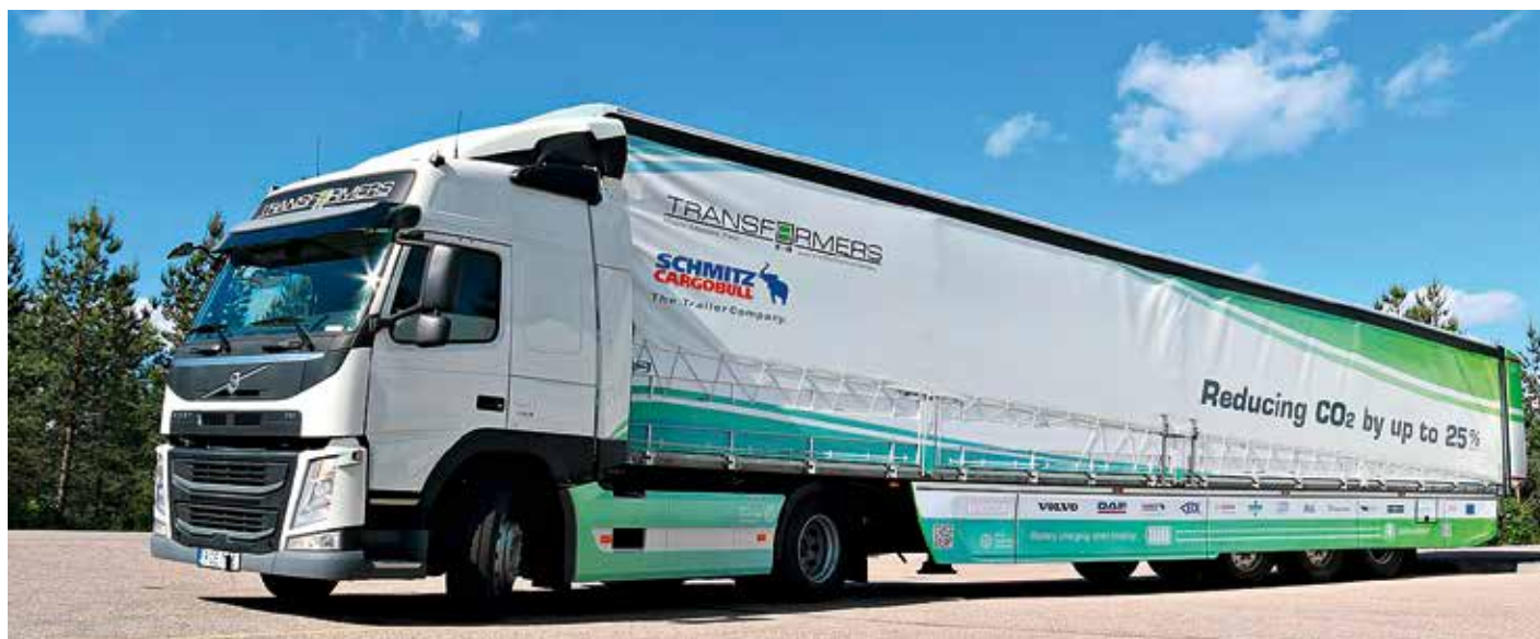
Sattelgespann aus Zugmaschine und Hybrid-on-Demand-Trailer.
