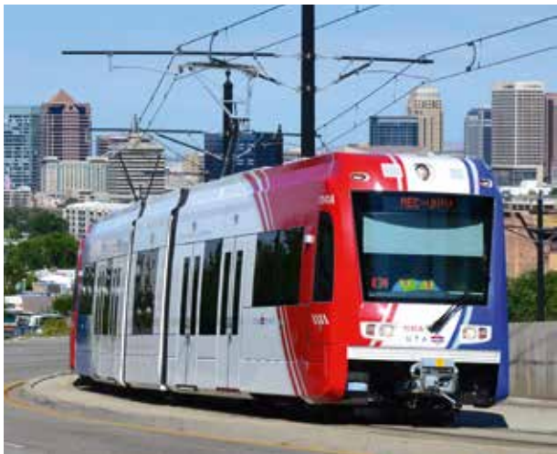
Außenverkleidungen aus Durostone® GFK-Profilen am AVANTO in Salt Lake City.
