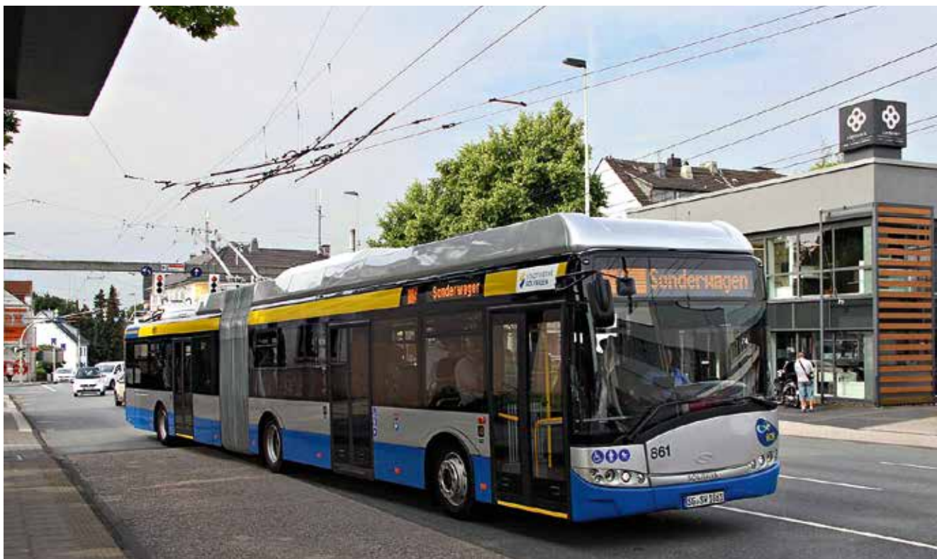
Musterstadt Solingen: Durch die Einführung von 20 Batterie-Oberleitungsbussen (BOB) über die Projektlaufzeit wird es möglich, bislang teilelektrische oder sogar reine Dieselbuslinien komplett elektrisch zu befahren.
