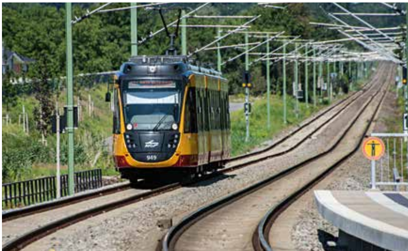
Karlsruher Albtalbahn: Die Straßenbahnen der Regionalbahnlinie können sowohl auf innerstädtischen Straßenbahnschienen als auch auf dem Eisenbahnschienennetz der Deutschen Bahn fahren. Demnächst sollen autonomen Testfahrzeuge den Versuchsbetrieb aufnehmen.
