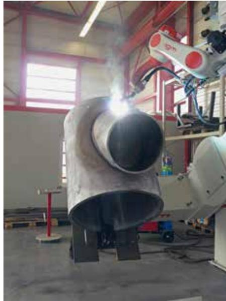
Bild 2: Robotergestützte schweißtechnische Fertigung von Jacket-Knoten.
