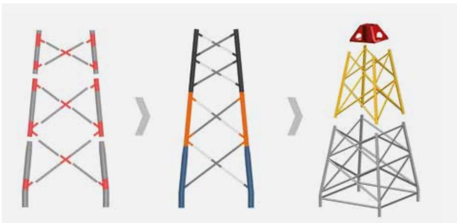
Bild 1: Salzgitter „Supply Chain“ Konzept für einen kosteneffizienten Offshore-Jacketbau basierend auf vollmechanisierter Vorfertigung von Knoten und Komponenten.
