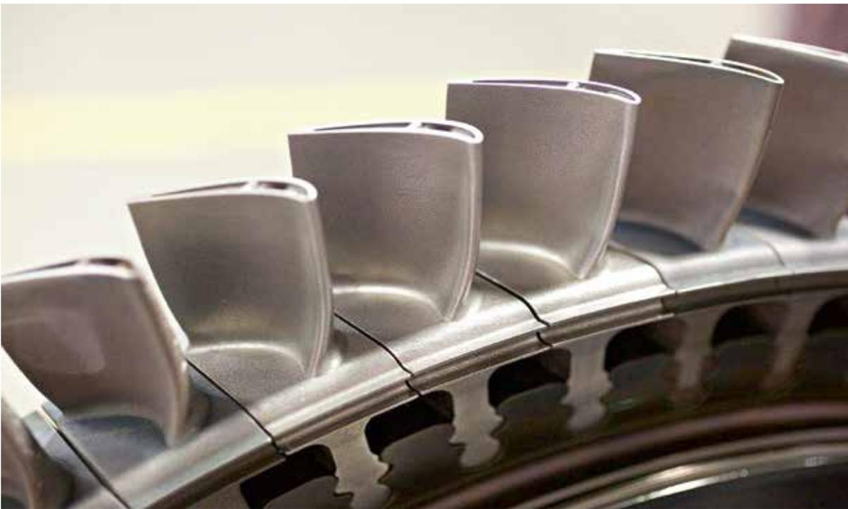
Extreme Bedingung für die Schaufeln aus dem 3D-Drucker: Die Schaufeln waren 13 000 Umdrehungen in der Minute und Temperaturen von über 1 250 Grad Celsius ausgesetzt.
