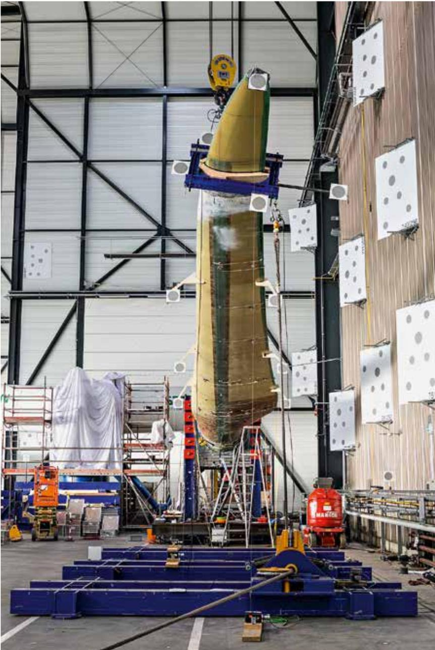
Die optischen Messschilder an der Hallenwand detektieren die Verformung in den drei Hauptachsen des Blattes.
