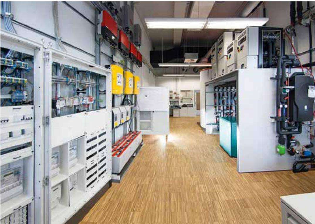
Aufbau im SmartEnergyLab des Fraunhofer ISE. Das Labor bietet eine optimale Simulations- und Testumgebung für intelligente Gebäudeenergiesysteme. Im Zuge des Projektes wird dort eine Rundsteueranlage integriert, um die Kommunikationsstrecke sowie intelligente Regler zu testen.
