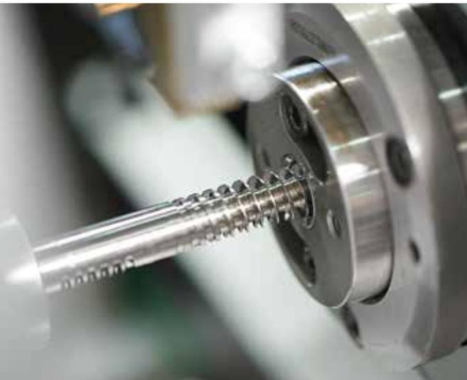
Spannung Knochenschraube in Tiefbohrmaschine.
