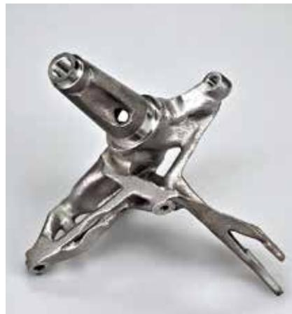
Strukturoptimierter Radträger eines Ultraleichtfahrzeugs: Design für Additive Manufacturing – Herstellung im 3D-Drucklabor Metall und Strukturwerkstoffe am Fraunhofer EMI.
