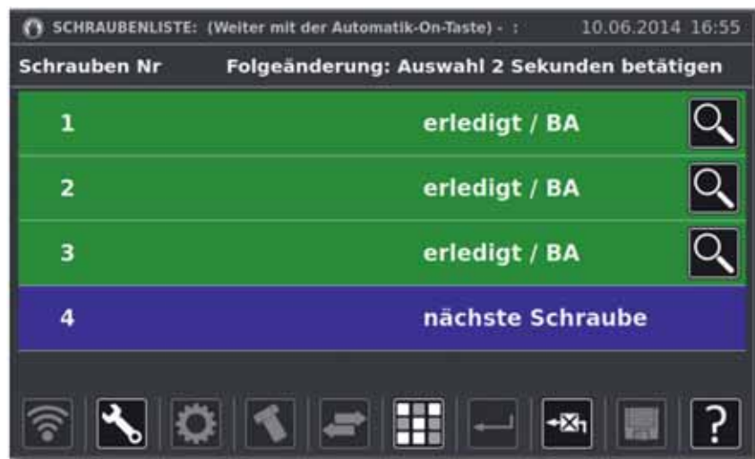
Innovative Technik unterstützt erfahrene Monteure: Sicher und korrekt verschraubte Verbindungen werden grün angezeigt.
