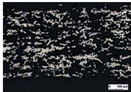
Poröse papierabgeleitete Edelstahlstruktur 1.4404 (nach Sinterung), Gesamtporosität ca. 70 %.
