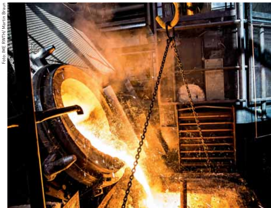
Die metallurgische Verwertung wertvoller Sekundärrohstoffe: Der letzte Schritt im Rahmen der MetalSens-Prozesskette.
