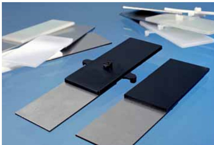
Im Spritzgussprozess hergestellte Hybridverbindung.
