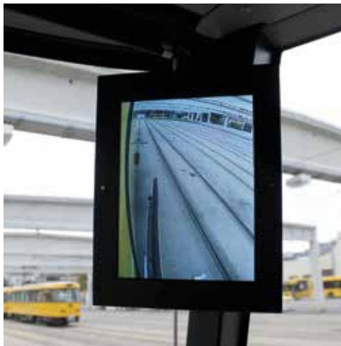
Echtzeit-Rückspiegelsystem bei der DVB in Dresden.
