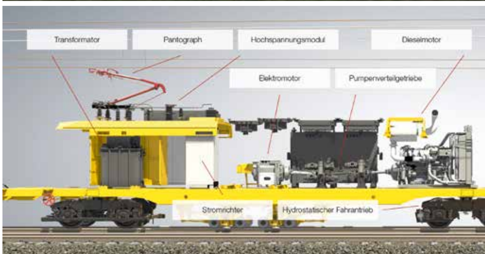
Tunnel-Inspektionsfahrzeug TIF während einer Testfahrt (oben) Der neue Hybridantriebswagen (unten)
