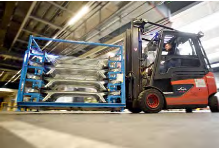
Brennstoffzellen-Flurförderzeuge im Mercedes-Benz Werk Düsseldorf: Die Auswertung der bisherigen Erfahrungen durch die FH Hamm zeigt ein hohes Potenzial für die Intralogistik
