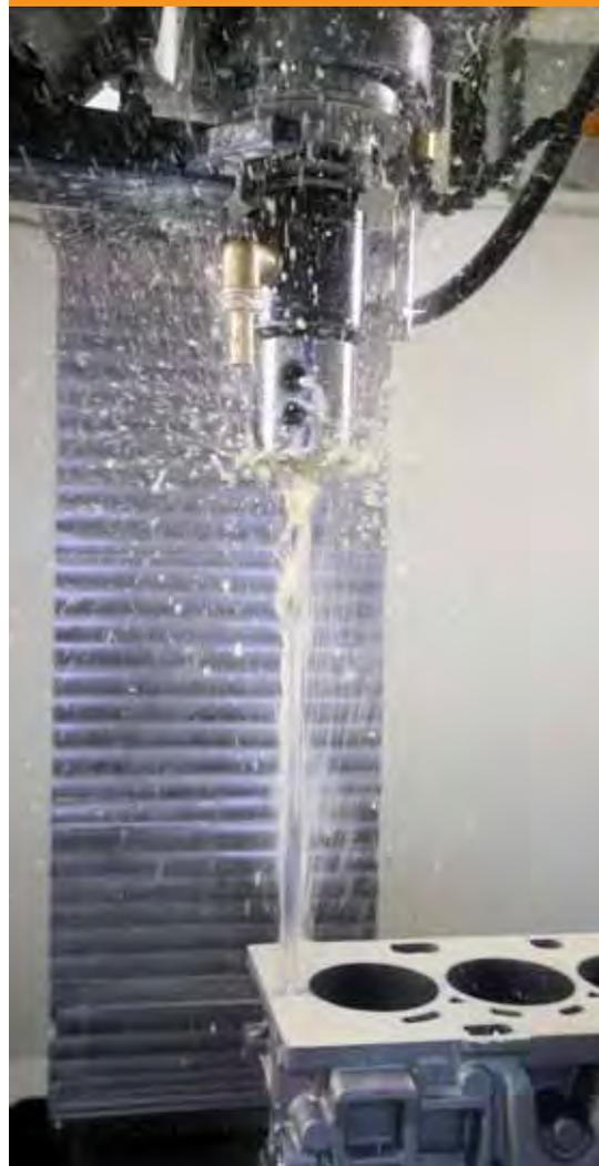
Maschinen, die keine innere KSS-Zuführung haben oder bauartbedingt keine hohen Drücke zulassen, können mit der **botek Kühlschmierstoffzuführung** nachgerüstet werden.
