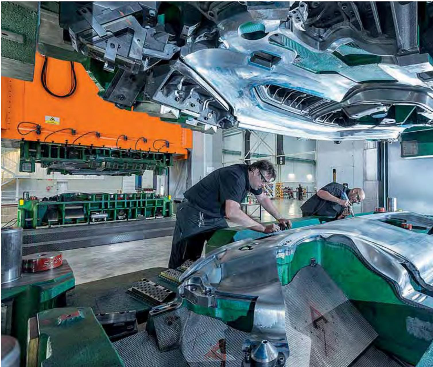
Die Sparte Werkzeugbau der Audi AG aus Ingolstadt deckt die komplette Kette der Blechteileherstellung von der frühen Design-Beratung über die Erstellung von Karosseriewerkzeugen und den Anlagenbau bis hin zur Inbetriebnahme ab. Die Kernkompetenz des Audi-Werkzeugbaus liegt in der Herstellung von Werkzeugen zur Fertigung von PKW-Außenhautteilen mit höchsten Oberflächenanforderungen und schwer zu bearbeitenden Strukturteilen, beispielsweise pressgehärteten Umformteilen.
