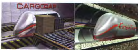
Bild 2: Schema eines unterirdischen Paletten-Transportsystems Quelle: http://www.cargocap.de
