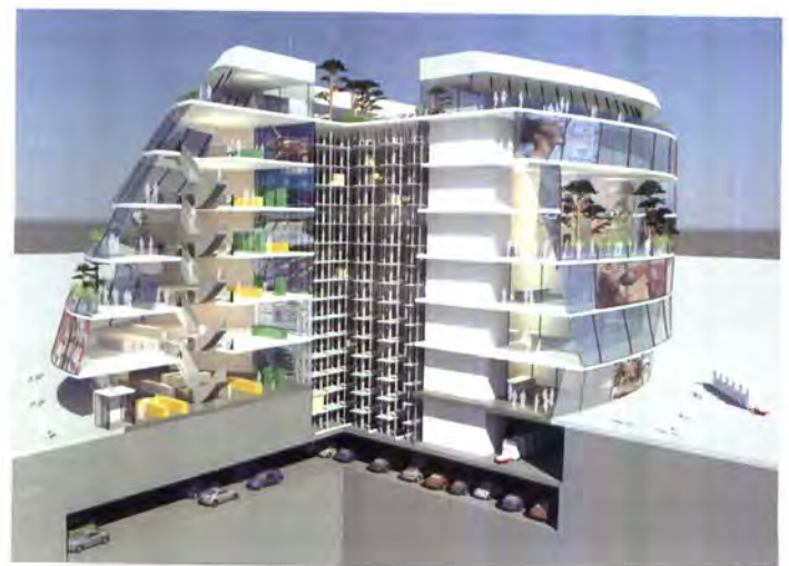
Bild 4: Konzept für das Lager-Logistikzentrum mit City-Logistik-Funktion und Erlebnis-Einkaufszentrum als 3D-Schnittdarstellung
