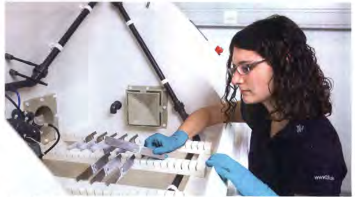
Die Materialproben werden in der Korrosionsprüfanlage einem mehrwöchigen Test unter variierenden Bedingungen ausgesetzt Foto: DLR
