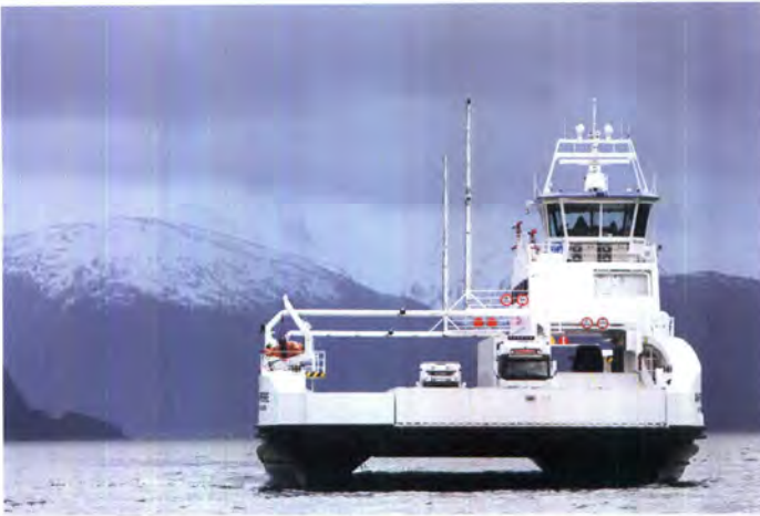
Die vollständig elektrische Fähre fährt in jeweils etwa 20 Minuten 34 mal am Tag die sechs Kilometer über den Fjord.
