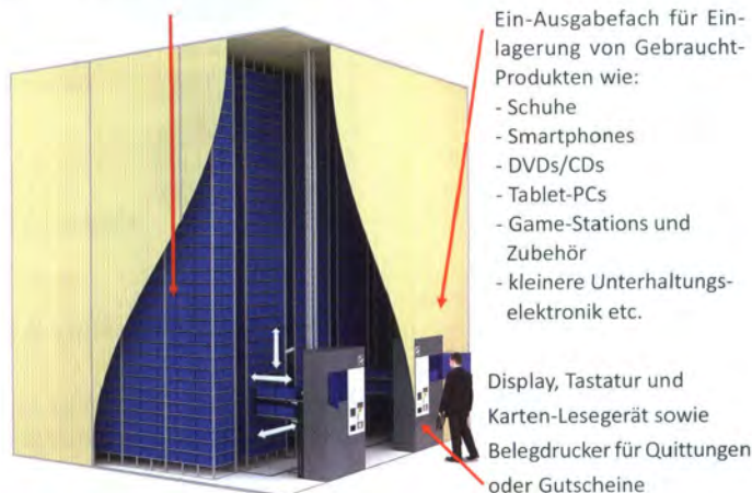
Bild 5: Schnitt durch den „iStore-Automaten“
