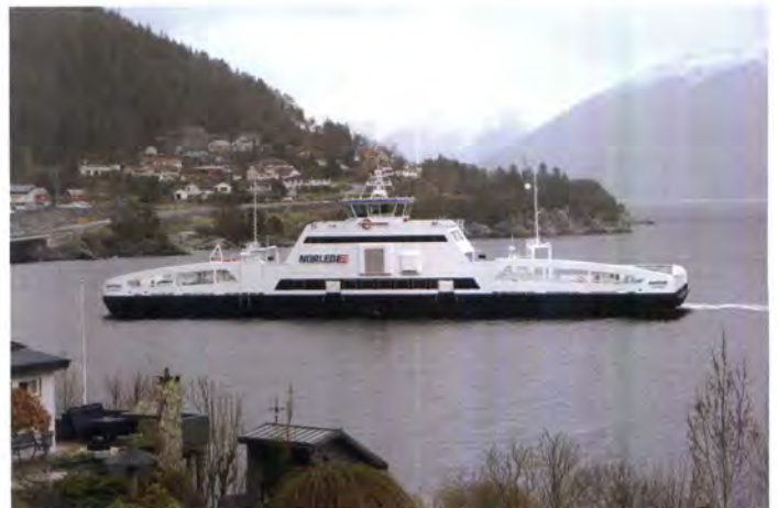
Die vollständig elektrische Fähre fährt in jeweils etwa 20 Minuten 34 mal am Tag die sechs Kilometer über den Fjord.
