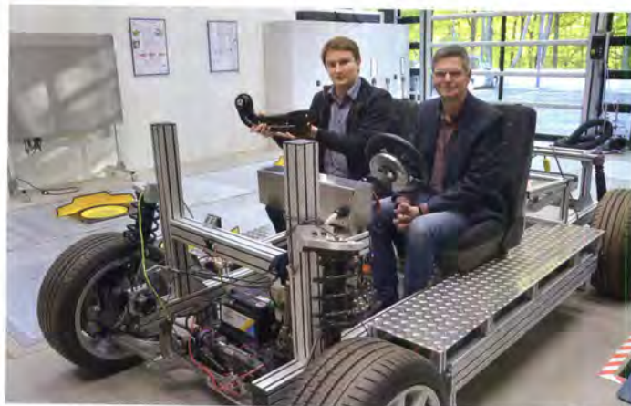
Dimitri Butakov (l.) und Prof. Dr. Andreas Nevoigt : Der aus Stahl hergestellte Fahrwerkslenker, den Dimitri Butakov zeigt, ist auch „noch“ im Demo-Fahrgestell der Fachhochschule eingebaut
