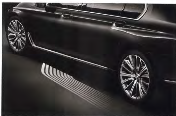
Mikrolinsen projizieren das Licht auf den Einstiegsbereich der Autotür Foto: BMW
