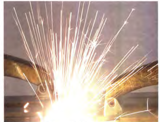
Laserschweißen von Stahl an Aluminium Foto: LZH
