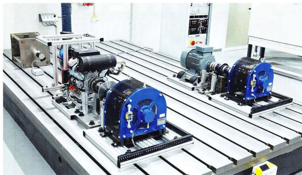
Drehschwingungsprüfstand zur Überprüfung des Simulationsansatzes
