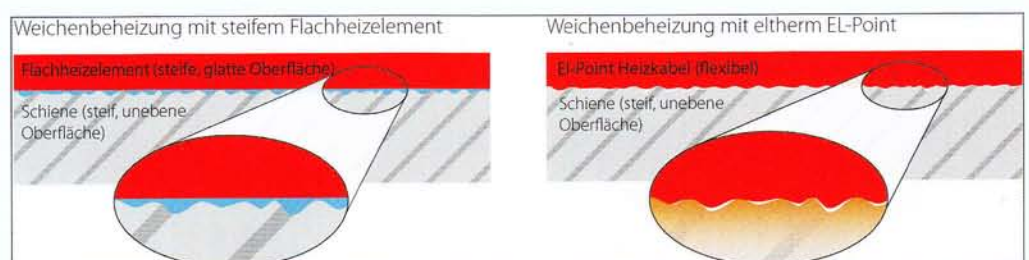
Das EL-Point-System im Vergleich zu herkömmlichen Weichenbeheizungssystemen mit Flachheizelementen
