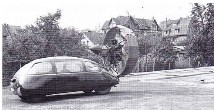
Für eine Testfahrt wurde der Schlörwagen mit einem Propeller mit 130 PS ausgestattet
