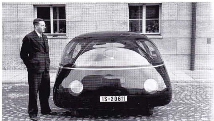
Die Karosserie ist so weit nach außen gezogen, dass sich die Vorderräder innerhalb der Karosserie drehen können. Dadurch wird die Aerodynamik wenig gestört.
