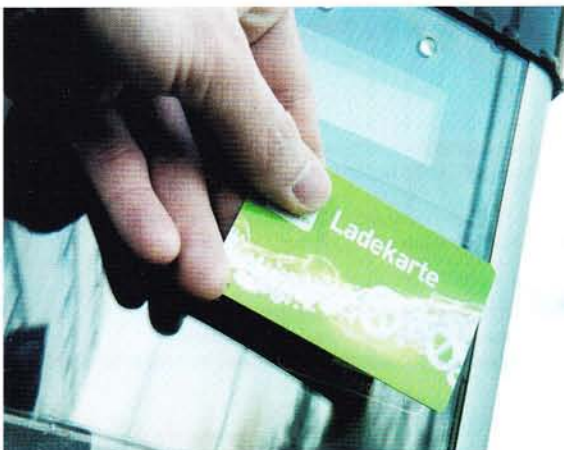
Bild 1: Per Chipkarte identifiziert sich der Nutzer an der Ladesäule. So gelangen standort- und personenbezogene Daten ins Abrechnungssystem
