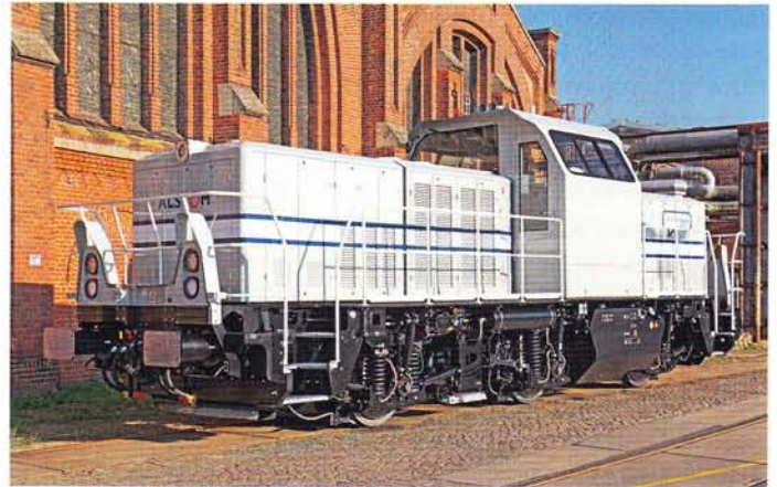
Der Antrieb der H3-Hybrid-Rangierlokomotive besteht aus einem 350 kW Dieselgenerator und einem Batteriepack
