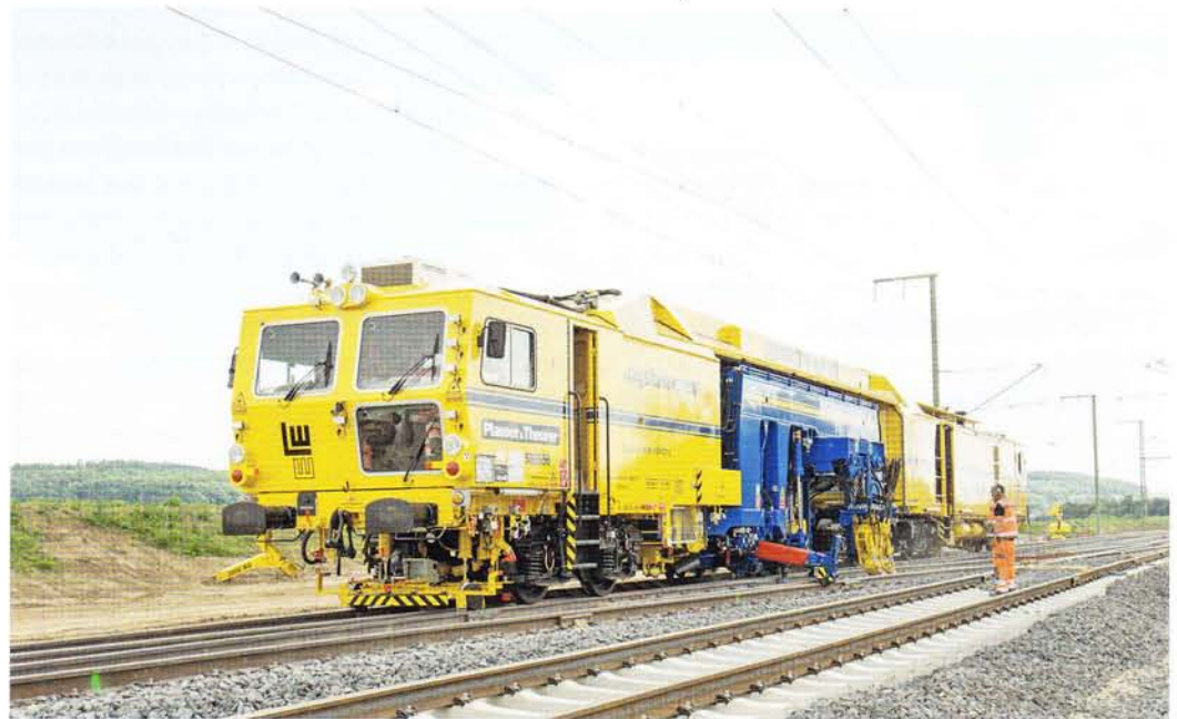
Weichenstopfen leicht gemacht – kontinuierlich arbeitender Unimat 09-4x4/4S
