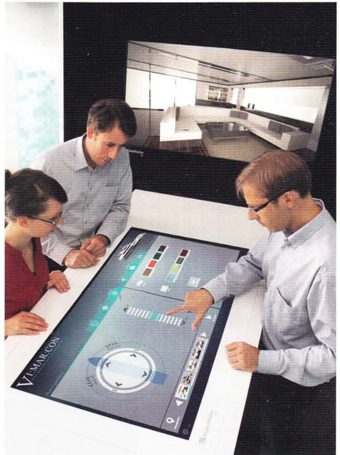
Mit dem Virtual Maritime Interior Configurator haben die Forscher des Fraunhofer IGD ein System entwickelt, mit dem sich das Interieur einer Yacht oder eines Kreuzfahrtschiffes bereits vor dem eigentlichen Bau mittels VR-Technologien in einem 3D-Modell gestalten lässt.
