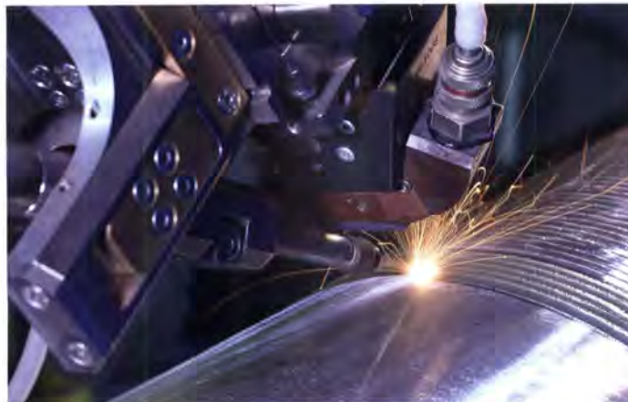
Laserbeschichten verdrängt zunehmend herkömmliche Härteverfahren im Bereich der industriellen Stahlverarbeitung etwa bei der Beschichtung von Walzen
