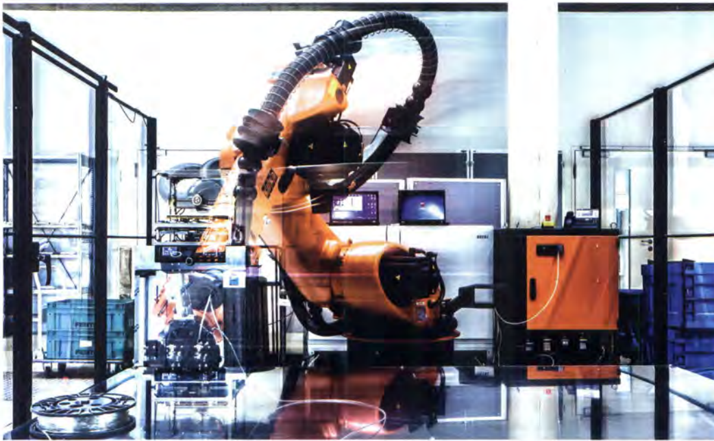
Der 3D Fibre Printer erzeugt thermoplastische Bauteile aus Faser-Kunststoff-Verbund
