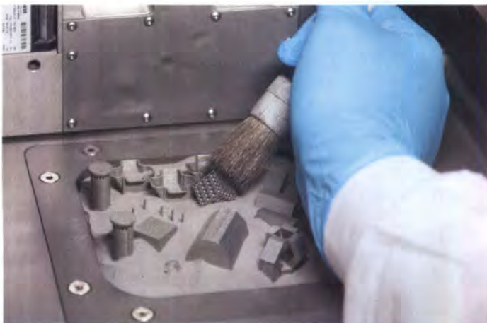
Schicht für Schicht schmilzt der Laser das neue Bauteil aus dem Metallpulver
