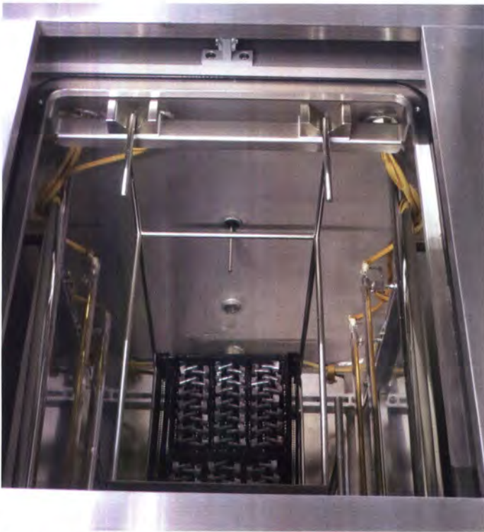
Der Vierseitenüberlauf verhindert die Rückkontamination der Teile beim Herausnehmen
