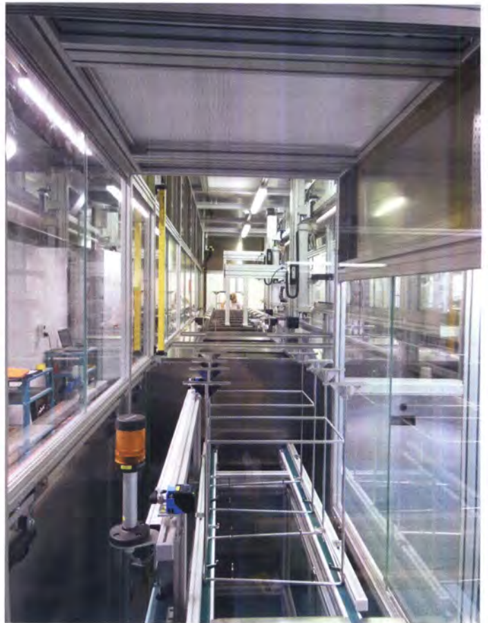
Ultraschallanlagen für die Feinstreinigung von Sensor- und Messelemente-Bauteilen
