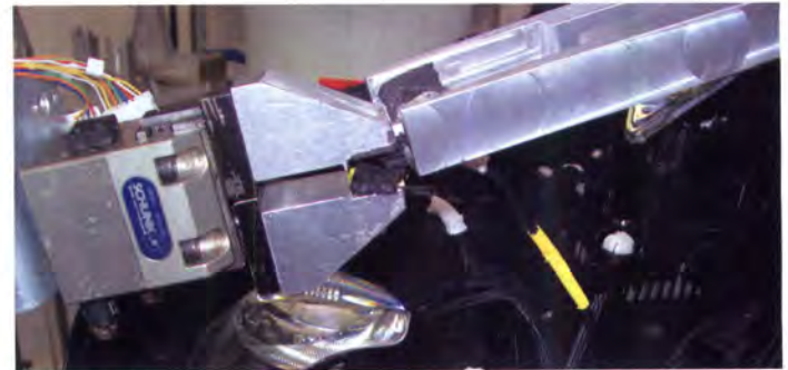
Bild 3: Umgreifen eines Steckers zwischen beiden Roboterarmen im kooperierenden Betrieb
