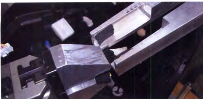
Bild 3: Umgreifen eines Steckers zwischen beiden Roboterarmen im kooperierenden Betrieb
