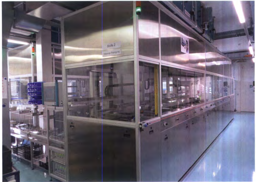
Die Anlage verfügt über insgesamt drei wässrige Reinigungsstufen und mehrere Spülstufen
