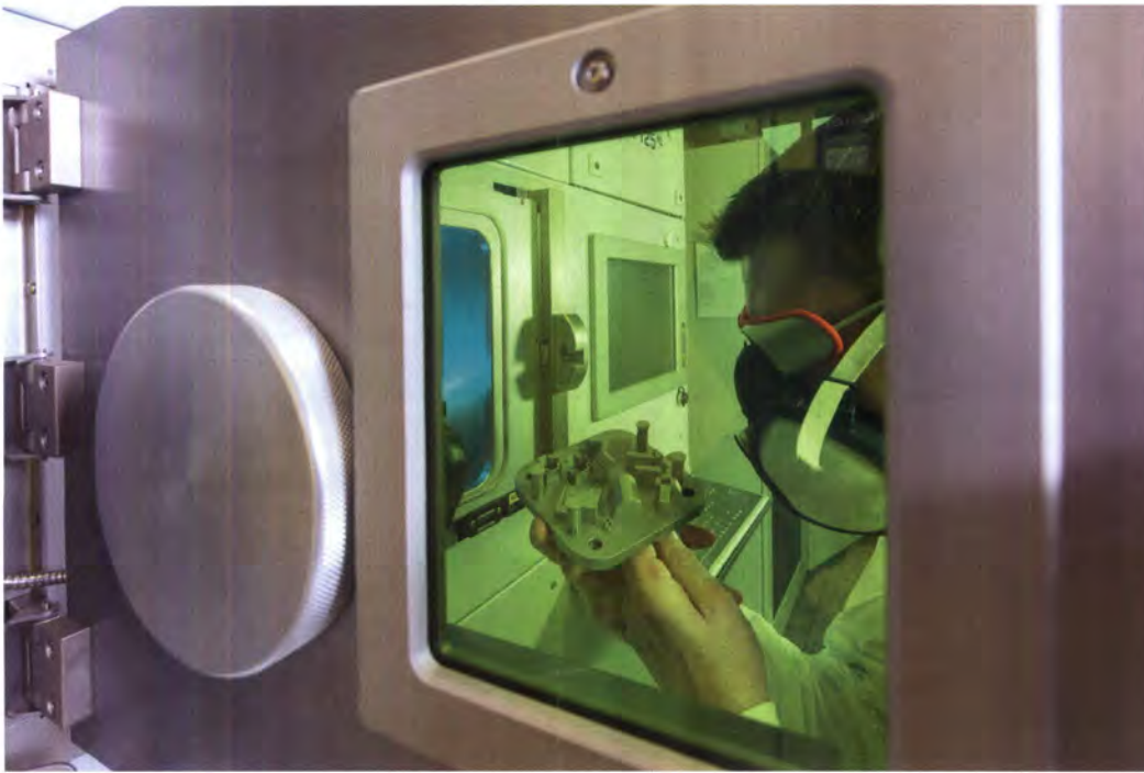
Die Werkstücke benötigen wenig Nacharbeit im Gegensatz zu herkömmlich produzierten Teilen, da sie in der Prozesskammer gefertigt werden
