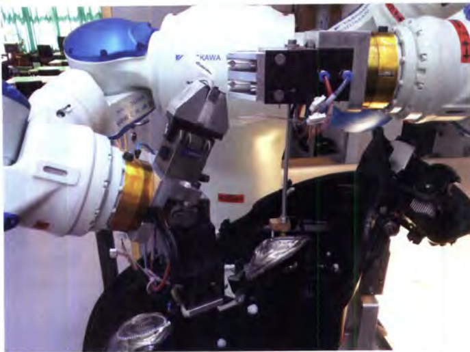
Bild 2: Im koordinierten Betrieb beider Roboterarme wird ein Lichtmodul montiert
