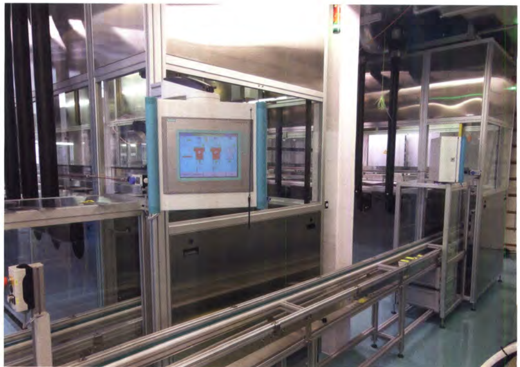
Der Prozess läuft vollautomatisch ab. Das entsprechende teilespezifische Reinigungsprogramm wird anhand des Barcodes gewählt.
