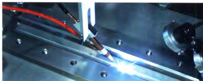
Mehrlagen-Engstspaltschweißverfahren an einem 50 mm Blech
