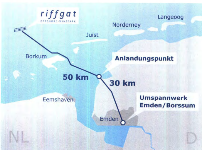
Das Umspannwerk wurde mit 50 km Seekabel mit dem Anlandepunkt an der ostfriesischen Küste verbunden Graphik: EWE AG
