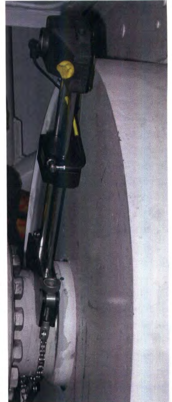
Bild 2: Montierter Sensor mit RF-Modul zur kabellosen Datenübertragung
