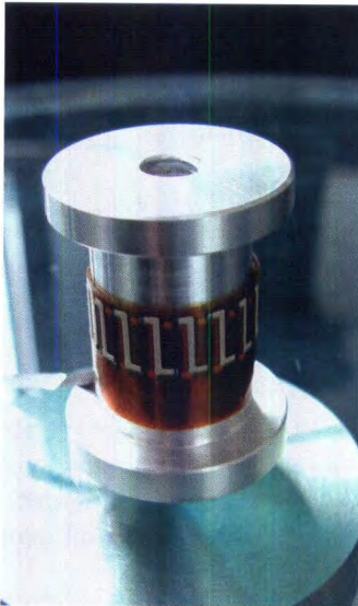
3D-Druck macht's möglich: Ein erster Demonstrator eines gedruckten thermoelektrischen Generators windet sich geschmeidig um ein Musterbauteil.
