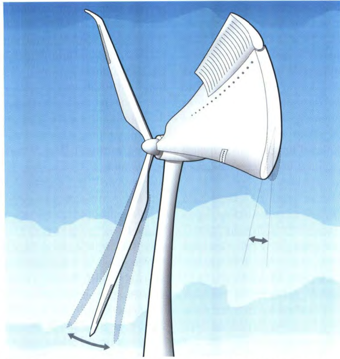
Durch Klappen im Rotorblatt, die den Wind umlenken und bewegliche Hinterkanten und Vorflügel sollen sich Rotorblätter in Zukunft besser und schneller an die lokalen Windströmungen anpassen können.
