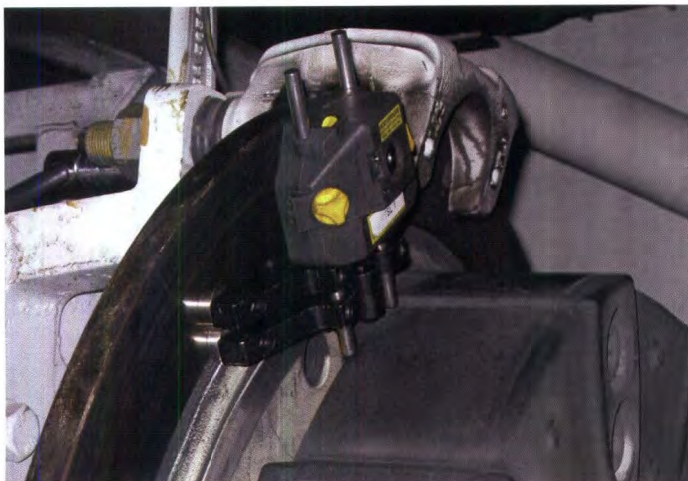
Bild 1: Lasermontage: Hier ist der Bremsklotz erkennbar, der bei jeder Wellendrehung im Weg steht
