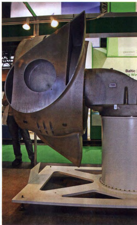
Beim Nabengenerator werden die Blattansätze beziehungsweise die Rotorblätter direkt auf dem Außenläufer des Generators angebracht und nicht mit einer Nabe vor dem Generator verbunden Foto: Fraunhofer IWES
