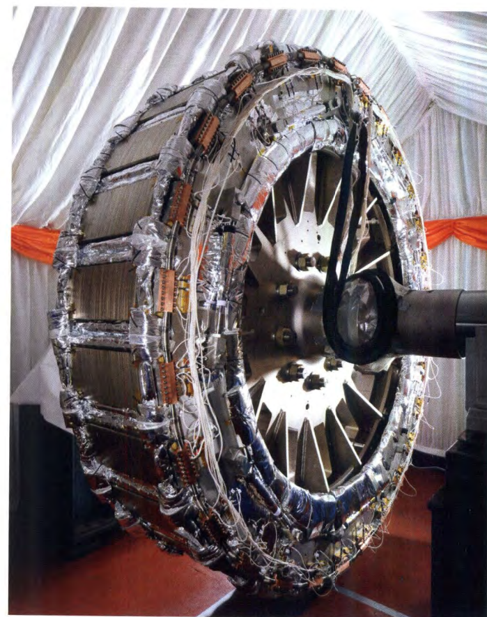
Die Supraleiter ermöglichen Wicklungen mit Drahtdurchmessern von lediglich 2 Prozent einer konventionellen Kupferdrahtwicklung
