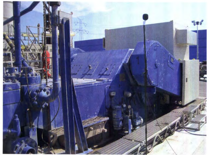
Bild 1: Spülpumpenaggregat mit eingehauster Antriebsmotoreinheit
