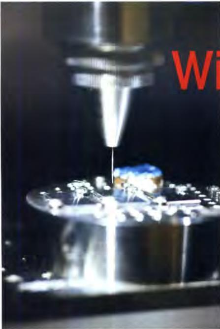
**Bild 1:** Die Raster-Kelvinsonde misst elektrochemische Potentiale an Grenzflächen
