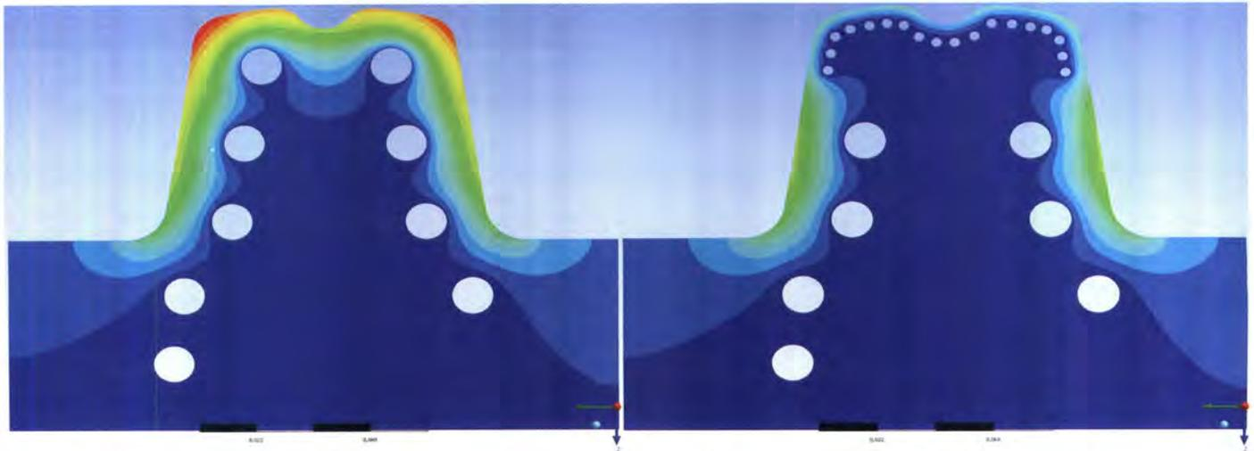
**Bild 3:** Ergebnisse der Thermofluid-Simulation für die verschiedenen Kühlkanalvarianten: Vergleich der Maximaltemperatur des Werkzeugeinsatzes an der Oberfläche im Presshärtenprozess: links Serienwerkzeug mit konventionell gebohrten Kühlkanälen 191°C, rechts optimale Variante mit geringster Werkzeuoberflächentemperatur 81°C
