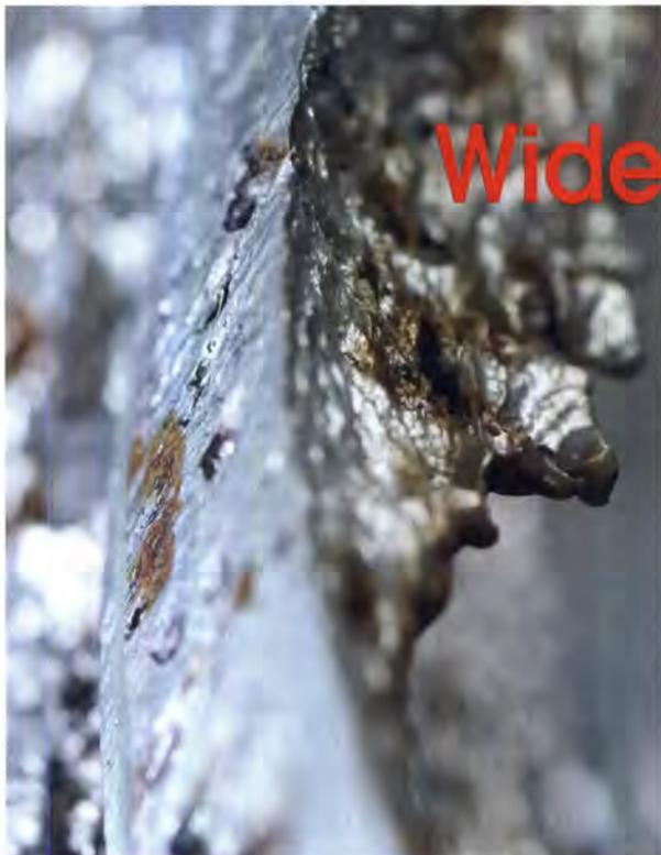
**Bild 1:** Verschlissenes Schaufelrad einer Pumpe, die sie 1995 eine Gipssuspension gefördert hat. Bei einer durchschnittlichen täglichen Laufzeit von 12 Stunden kann man eine Gesamtbetriebszeit von 70.000 Stunden annehmen
