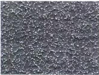
**Bild 2b: Pulvermetallurgische Legierung mit 10 % Niobkarbid, das besonders fein ist**
