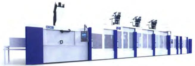
**Bild 2: Neuentwickelte BOREHONE-Anlage für die Fertigbearbeitung von Zylinderbohrungen**
