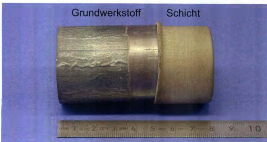
Bild 3: Mittels Sintercladding beschichteter Demonstrator bestehend aus einem Grundwerkstoff aus S355 ( d=40 mm) und einer hoch-verschleißbeständigen Schicht aus Kaltarbeitsstahl mit einer Dicke von 25 mm
