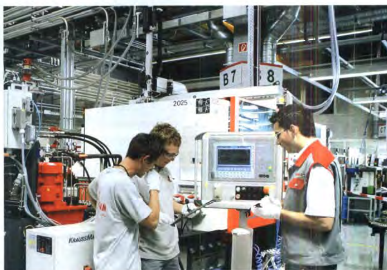
Beim DirectSkinning-Verfahren werden Spritzguss und Reaktionstechnik in einer Anlage zusammengeführt.
