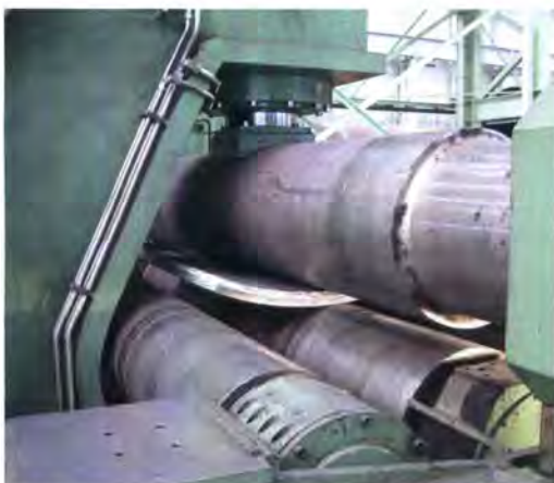
Der Stützbügel unterstützt die Walzen beim Anbiegen.
