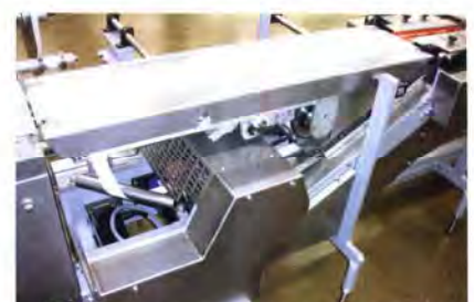
Inline-Kartonunterlagenzuführung mit Kartonschneider unterhalb des Transportbandes
