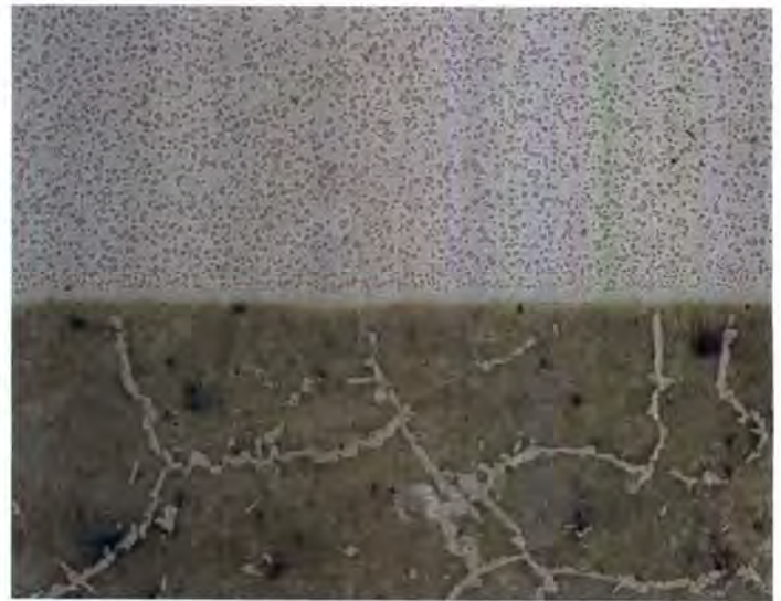
Bild 2: Gefügebild einer Grenzfläche zwischen einem Bauteil aus S355 (unten) und einer Schicht aus einem karbidreichen Kaltarbeitsstahl mit kleinen Karbiden (oben)
