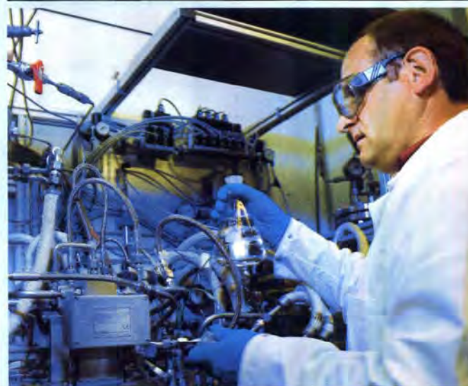
Bild 3 und 4: Dr. Ricarda Leiberich (o.) und Peter Lobert (u.) analysieren Reaktionsverläufe in einer eigens konstruierten Messzelle mit Infrarotlicht, Video-Mikroskopie und viel Mathematik.
