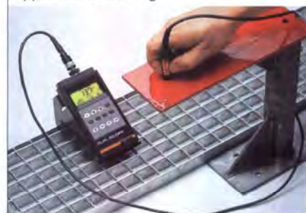
Messung der Lackdicke auf verzinktem Stahl
