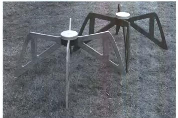
LOFAR-Antennen für Radio-Wellenlängen 1-3 Meter. Je 96 Antennen beider Typen bilden eine Station.
