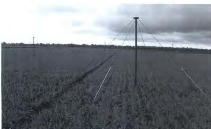
LOFAR-Antennen für Radio-Wellenlängen 4-10 Meter. Je 96 Antennen beider Typen bilden eine Station.
