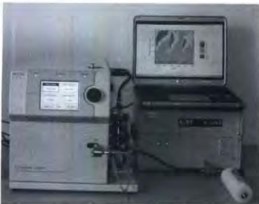
**Bild 3:** Mit dem SMPS (Scanner Mobility Particle Sizer) wird die Partikelanzahl gemessen
