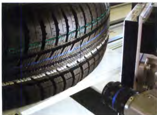
Bild 4: Farb-Bildverarbeitung zur Reifen-erkennung
