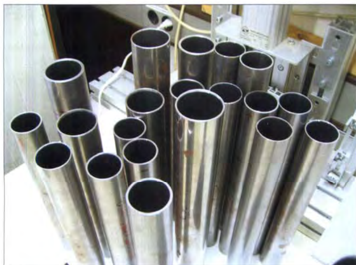
Bild 5: Inspektion und Vermessung von Rohrenden
