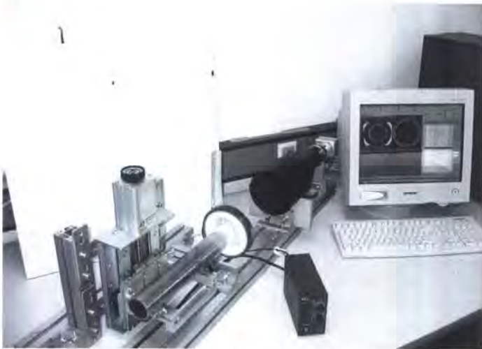
Bild 6: Versuchsstand zur Kontrolle und Vermessung von Rohrenden
