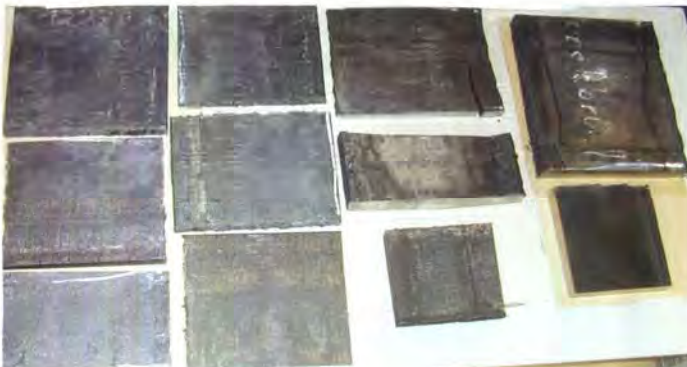
Bild 2: Ausschnitte von Brammen mit Defekten
