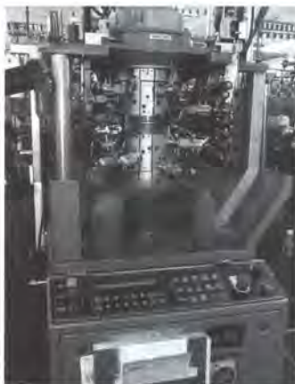
Computer gesteuerte Strick-Maschine
