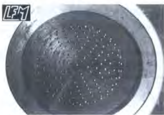
Bild 2: Düsenkonus mit Kühlbohrungen (Bohrungsdurchmesser ca. 125 µm)
