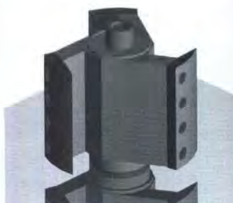
Bild 5: Konstruktionszeichnung Versuchsrotor mit bionischen Schneidwerkzeugen (l.), Aufbau der Multilayer-Composite-Beschichtung [2] (m.) und gefertigtes Funktionsmodell
