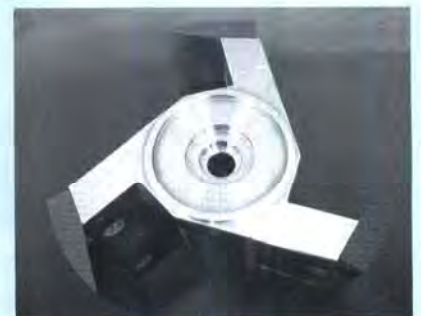
Bild 5: Konstruktionszeichnung Versuchsrotor mit bionischen Schneidwerkzeugen (l.), Aufbau der Multilayer-Composite-Beschichtung [2] (m.) und gefertigtes Funktionsmodell
