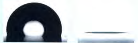
Bild 2: Wassertropfen vor der Belichtung (l.) und nach der Belichtung (r.). Die entstandene hydrophile Oberfläche zieht den Tropfen flach auseinander. Bild: INM
