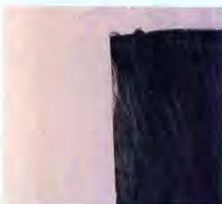
Bild 1: Laborprobe, beschichtet mit TiO_2 -Lack, halbseitig durch Licht aktiviert. An der belichteten Fläche (jeweils links) lässt sich anhaftender Schmutz durch Wasser vollständig wegspülen.
