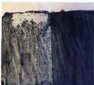
Bild 1: Laborprobe, beschichtet mit TiO_2 -Lack, halbseitig durch Licht aktiviert. An der belichteten Fläche (jeweils links) lässt sich anhaftender Schmutz durch Wasser vollständig wegspülen.
