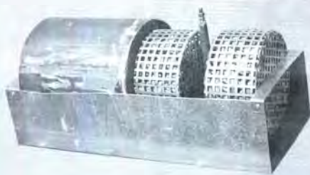
Demonstrationsmodell in zylindrischer Ausführung mit Flammrohr variabel anpassbar
