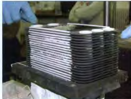
Bild 2: SOFC-Kassettenzelle und Shortstack-Anordnung für APU-Anwendungen beim DLR Stuttgart
