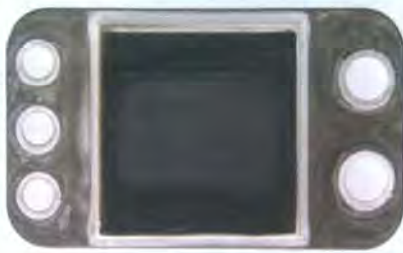
Bild 2: SOFC-Kassettenzelle und Shortstack-Anordnung für APU-Anwendungen beim DLR Stuttgart
