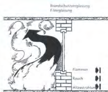
Bild 2: Am Beispiel der F-Verglasung soll der Raumabschluss durch die Darstellung der kurzen Pfeile verdeutlicht werden.
