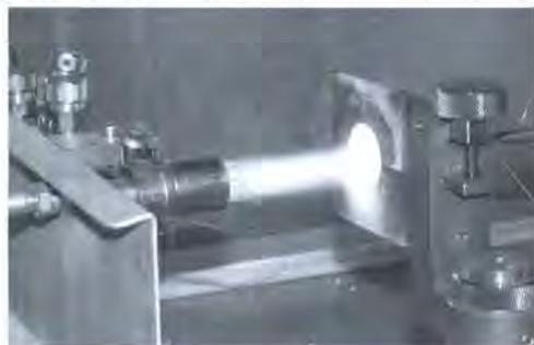
Die neuen Wärmedämmstoffe werden bei extremen Temperaturen von über 1300 Grad getestet
