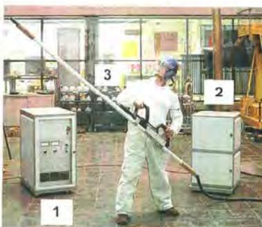
**Bild 2: Elektrotechnik-Student Mirko Wötzel am Versuchs-Handapparat (1 – Ladegerät, 2 – Kondensator-Schalter-Einheit, 3 – Handapparat)**
