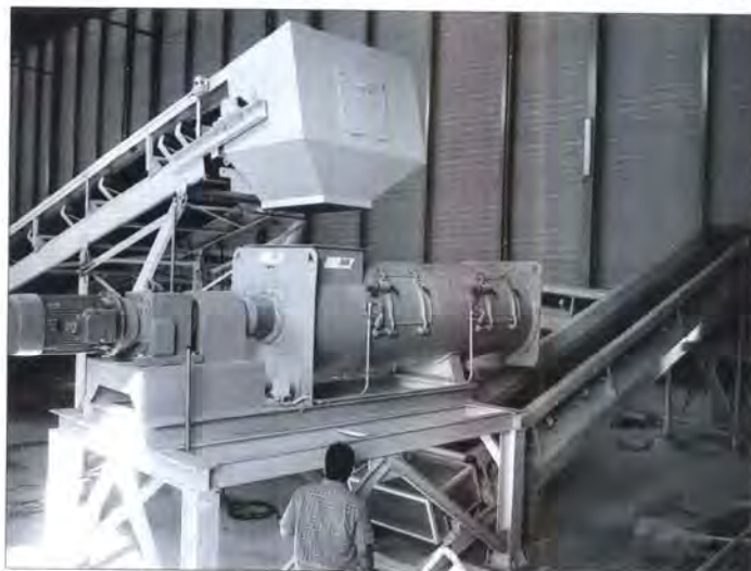
Der kontinuierliche Mischer HTK 3100 homogenisiert Grünabfälle mit dem Ziel, dass die Rottezeiten deutlich verkürzt werden. Der Kompost gelangt als Pflanz Erde wieder in den Verkauf. Der Mischer ist Bestandteil einer Anlage auf der Insel Mallorca
