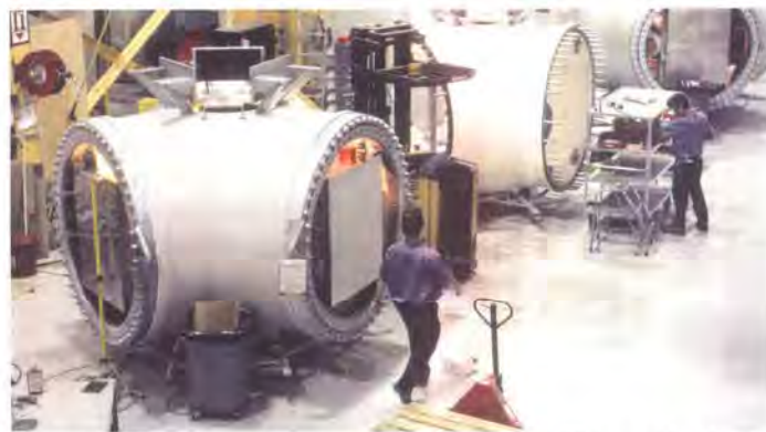
Gegossene Rotornaben werden hier kontrolliert und erhalten die Hauptverbindungen für den Anschluss der Rotorblätter. Foto: GE Wind Energy
