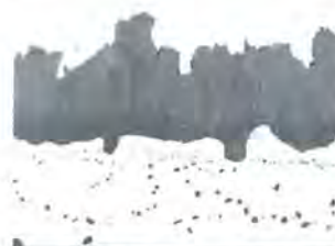
Querschnitt des Jülicher Werkstoffs im Raster-Elektronenmikroskop (Dunkle Schicht = schützende Oxidschicht nach 6000 Stunden an der Luft bei 800 Grad Celsius)
