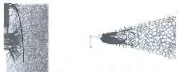
Abb. 8: Vertikal- und Horizontalschnitt mit Kontaktkräften durch die Modellkiste nach der Pfahlbelastung
