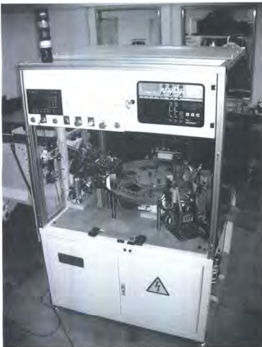
Bild 2: Der Prüfautomat kann bis zu 6.000 Kugelzapfen pro Stunde auf Oberflächenrisse und korrekte Wärmebehandlung vollautomatisch prüfen.
