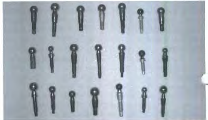
Bild 1: Kugelzapfen übertragen die Lenkbewegung auf die Räder.
