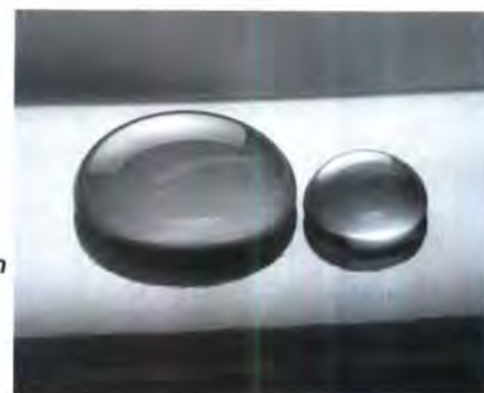
Bild 1: Nanostrukturen fördern das wasserabweisende Verhalten einer Oberfläche. Foto: Nanogate Technologies GmbH
