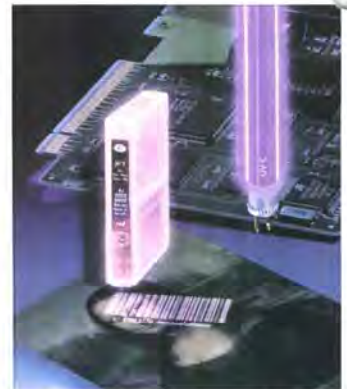
Bild 1: Fluoreszierende Nanopartikel als Fälschungsschutz. Unter Tageslicht ist die Markierung unsichtbar (links) unter UV-Licht erscheint sie als leuchtender Schriftzug (rechts).
