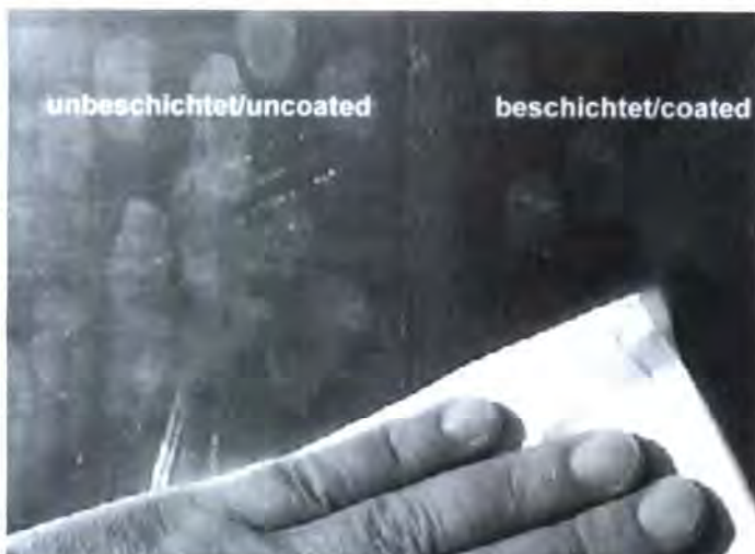
Bild 2: Antifingerprint-Beschichtungen lassen sich leichter reinigen. Foto: NANO-X GmbH
