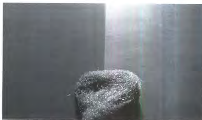
Bild 4: Ein komplett lackiertes Autoreifen halbseitig mit einem kratzfesten Lack beschichtet und mit Stahlwolle behandelt.
