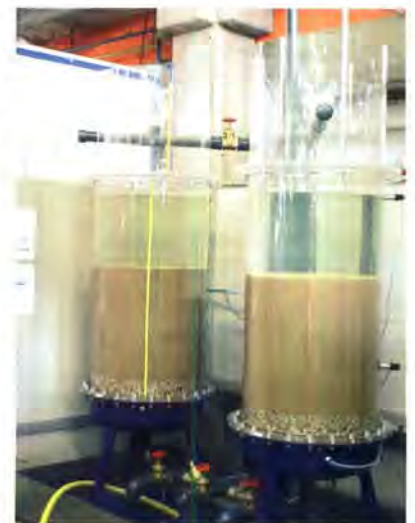
Bild 2: Der Schnellfilter entfernt die Trübstoffe aus dem Rohwasser
