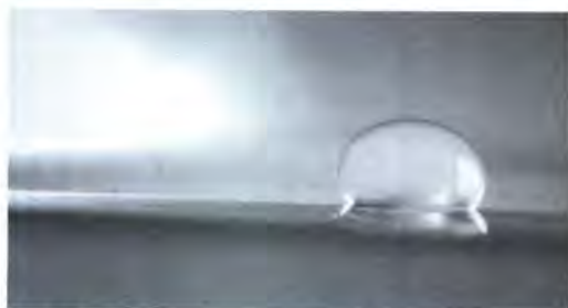
Bild 3: Wasserabweisende Schichten verringern den Reinigungsaufwand
