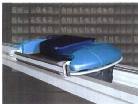
Bild 3: Dynamischer Gepäcktransport mit Hoch- geschwindigkeit am Flughafen Münster/ Osnabrück
