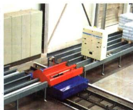
Bild 5: Prozess der Einlagerung durch Verfahren des shuttle-cars in der Lagergasse
