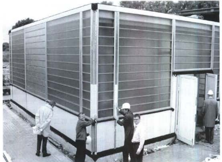
Am Modell des Distributionszentrums im Maßstab 1:10 werden die Einrichtungen praxisnah getestet.
