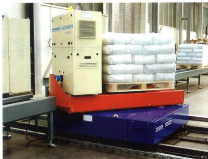
Bild 4: Transportprozess mittels paletstore®: Basisfahrzeug und shuttle-car
