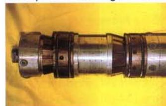
Mit der pneumatischen Innenspann-Vorrichtung können beide Rohrenden nacheinander gespannt werden.
