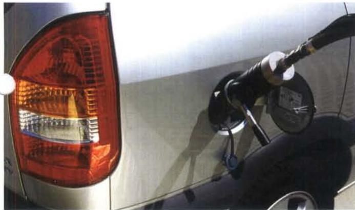
Der Gasfüllstutzen unterscheidet sich deutlich von den Benzinzapfstutzen.
