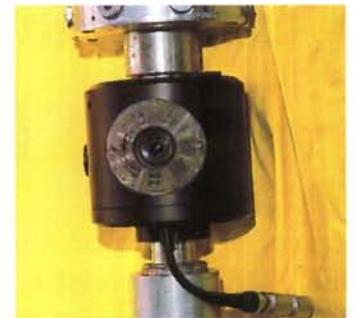
Ein Kamerasystem ermöglicht die direkte Begutachtung der Nahtwurzel.
