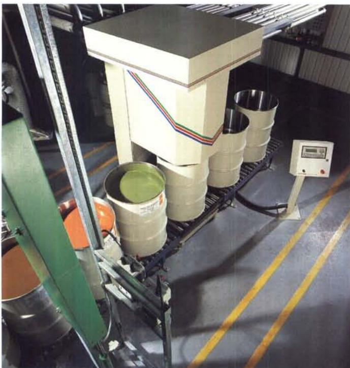
*Eine Lackmischstation, wie die Pevicoat® Anlage, ermöglicht die Just-in-Time-Produktion des Lacks direkt an der Beschichtungsanlage. Bild: BASF Coatings AG*
