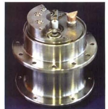
Ein Germanium-Detektor, eingeschweißt in eine Titan-Kapsel aus Jülich, misst Gammastrahlen auf dem Roten Planeten.
