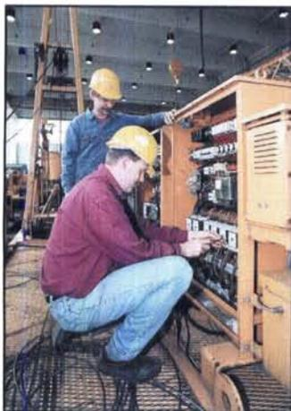
Bild 1: Überprüfungs- und Instandsetzungsarbeiten an der Steuerung eines großen Turmdrehkrans
