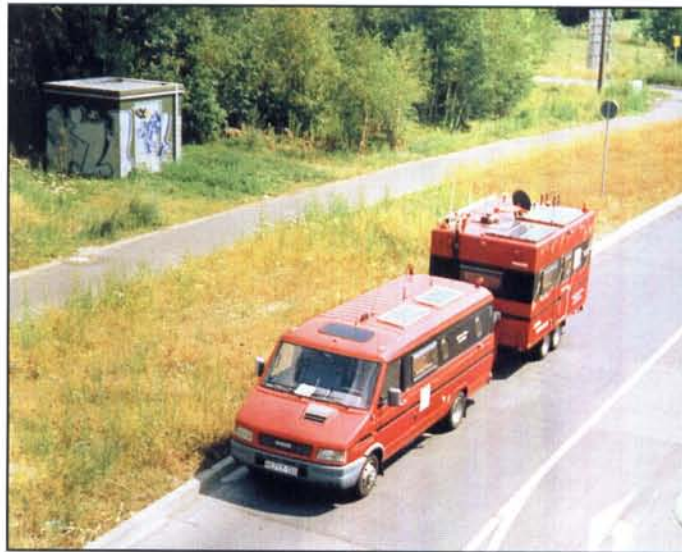
Die Solarzellen auf dem Auto liefern genügend Strom, um ein mobiles Büro mit PC, Fax, Daten- und Sprechfunkanlagen, Navigationstechnik und Beleuchtung zu versorgen.
