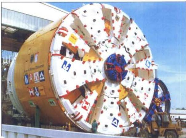
Für die 4. Röhre des Elbtunnels arbeitet sich die Tunnelvortriebsmaschine unter der Elbe durch.
