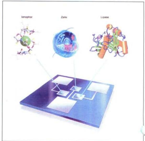
Prinzipieller Aufbau eines Biosensors: Er besteht aus einem Halbleiterchip als Transducer und biologischen und chemischen Komponenten als stofferkennende Membran
