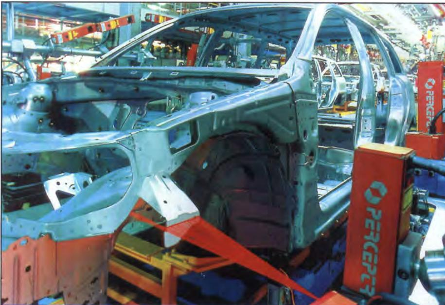
Die effektive Prozeßkontrolle wird durch ein lasergestütztes Verfahren ermöglicht, das die Maßhaltigkeit mit Hilfe einer elektronischen Bildverarbeitung prüft.
