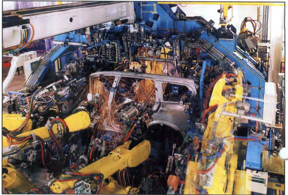
Die Preciflex Schweißanlage ersetzt eine komplette Schweißstraße mit mehreren Stationen. Die Reduzierung auf eine Station erhöht die Maßhaltigkeit im Produktionsprozeß.
