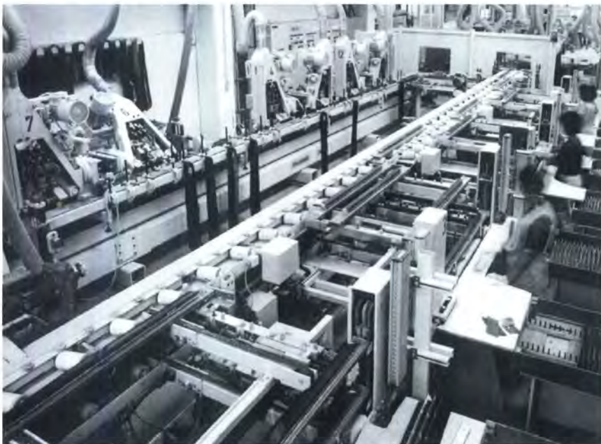
An den Bestückungsplätzen werden die Zierleisten manuell auf die Werkstückträger aufgebracht. Lichtschranken steuern die Übernahme und den Transport in die Pufferplätze. Foto: Wemhöner
