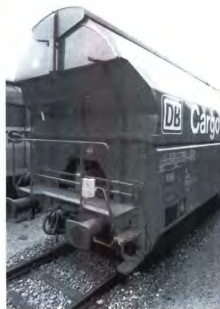
Sandy - das Satelliten-Handy - optimiert die Laufüberwachung von Güterwagen mittels Satellitenortung. Foto: DB AG / Mann
