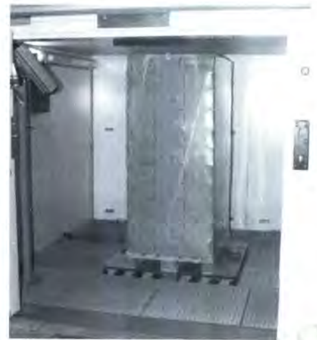
Abb. 1: Schwingprüfung einer Ladeeinheit unter Extremklima Foto: vdz
