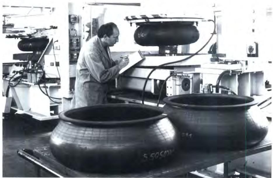
Lufffeder auf Elastomerbasis für Schienenfahrzeuge.
