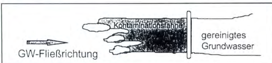
Prinzip der permeablen Reaktionswand nach Deutsch et al. 1996
